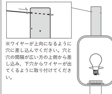
穴にワイヤーを差し込んで取り付けていきます。上がSサイズ、真ん中がMサイズ、下がLサイズのワイヤーとなります。
