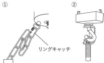
①リングキャッチのネジを緩めてチェーンの長さを調整、②引掛けプラグ下のコードホルダーを調整する事で本体の高さを調整することができます。
