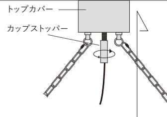
トップカバーを両手でしっかりと持ったまま天井へ押し上げ、上図の様に位置固定ボルトを穴に通します。固定ボルトを通したら、固定ネジをシーリングカップ留めネジで締め本体を固定してください。
