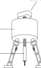
カップストッパー緩めて、カップ内の引掛けプラグを引き出し、天井配線器具に取付けます。
